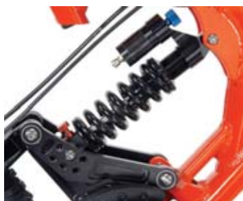
CSB-EPB18 应用于自行车后悬挂臂 CSB-EPB18 for rear suspension arm
